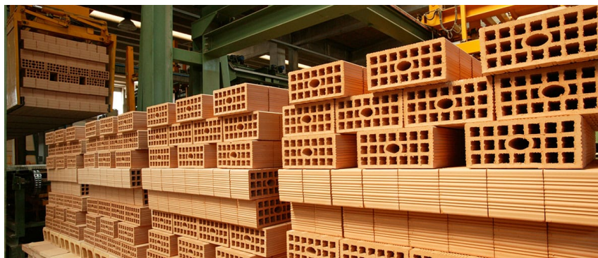
Uscita dei laterizi: mattoni doppio UNI dai forni continui
